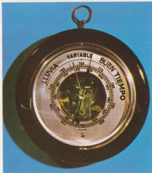
La presión atmosférica se mide por la altura que alcanza en un tubo una columna de mercurio de 760 mm., cuya presión equilibra la presión atmosférica a nivel del mar. Esto da lugar a un aparato llamado **barómetro**, que sirve para medir dicha presión. Actualmente se fabrican barómetros metálicos de esfera graduada en la que una saeta indica la presión.
